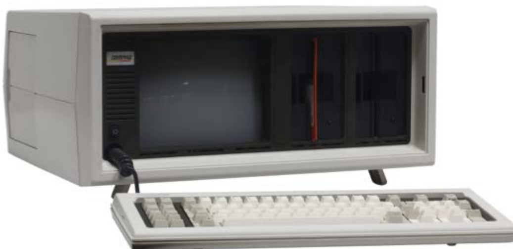
Bild (6): Portabler PC von Compaq – mit Röhrenbildschirm und nicht netzunabhängig – Gewicht: um die 20 kg (1983)
