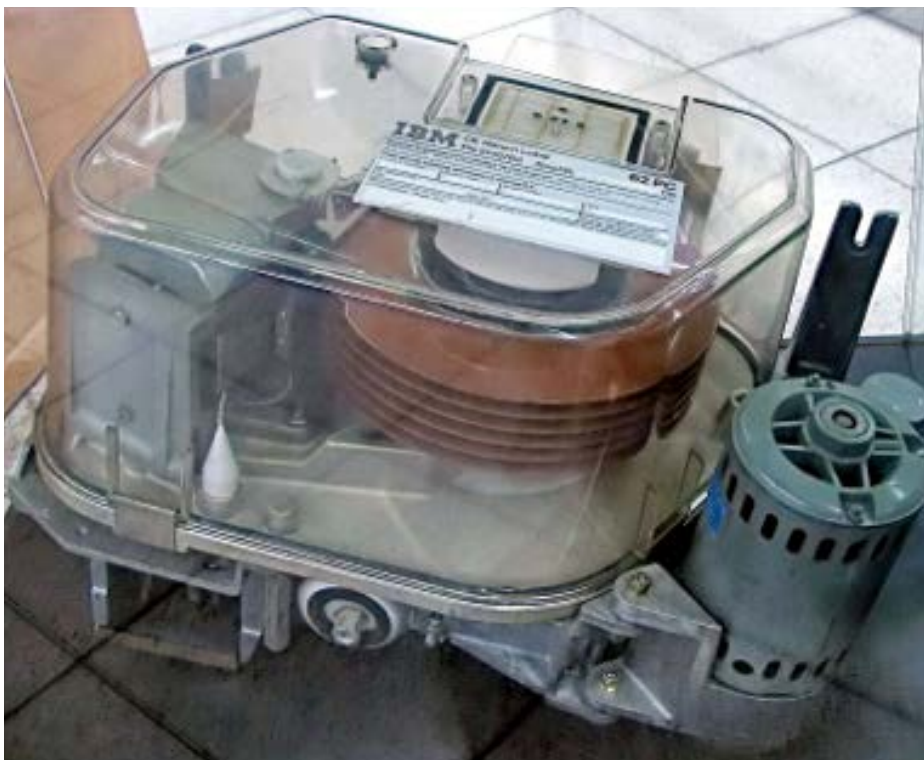
Bild (2): Der USB-Stick der 70er-Jahre – IBM-62-PC-Festplatte mit 65 MB Speicher
