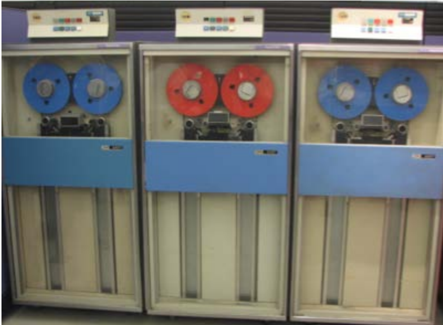
Bild (7): Irgendwie auch ein Vorläufer von Cloud, iPhone und Co. – Bandstationen für IBM System/360 aus den 60er-Jahren
